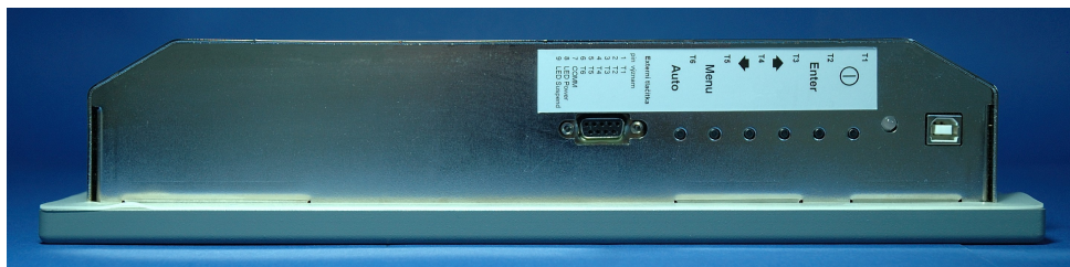
Ovládací tlačítka monitoru DataLab LCD 17T a USB-B konektor řídicí jednotky dotykové obrazovky
